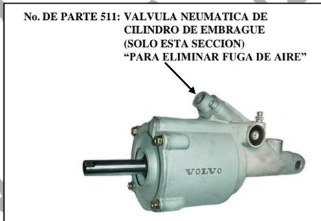
No. DE PARTE 511: VALVULA NEUMATICA DE CILINDRO DE EMBRAGUE (SOLO ESTA SECCION) "PARA ELIMINAR FUGA DE AIRE"
